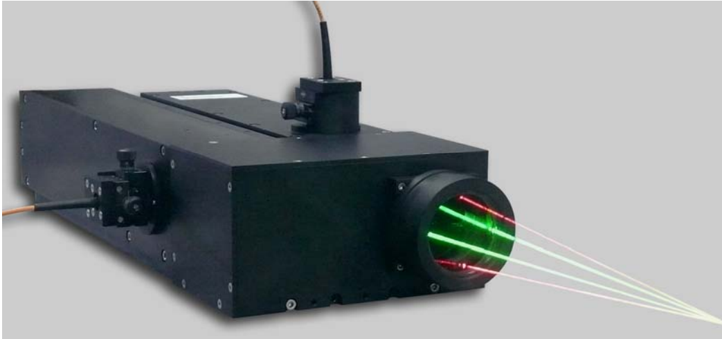
2D LDA-Sonde fp50 mit Strahlüberlagerung
